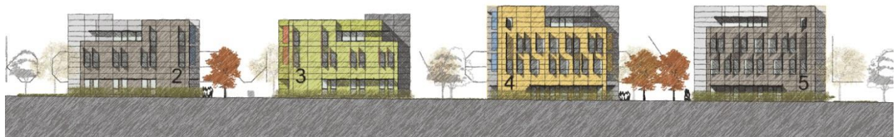
Principe d'épannelage des bâtiments de bureaux le long de la voie structurante
