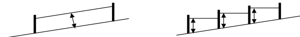
Elle est mesurée perpendiculairement à la pente ou à l'aplomb vertical en tout point de la clôture.
